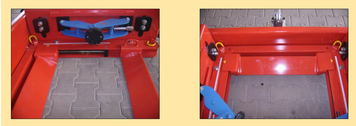
Die Radaufnahme besteht aus einem Grundrahmen der mit 2 verstellbaren Aufnahmekeile ausgestattet ist.
