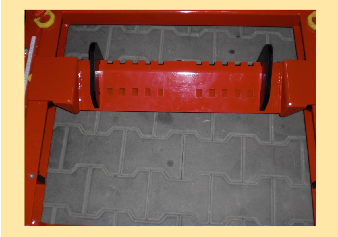
Mit den beiden Seitenanschlügen wird das Flugzeugrad gegen seitliches Verschieben fixiert.
