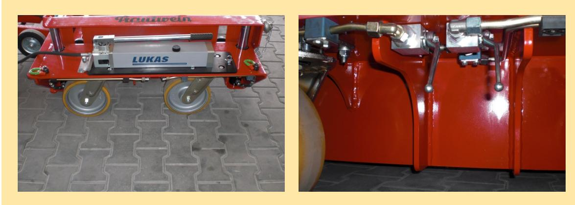
Das Bergedolly verfügt über eine hydraulische Hub- und Senkeinrichtung mit Handpumpe
