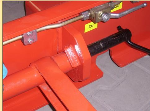
Die Zuggabel enthält ein ausziehbares Deichselrohr und kann von 2500 mm bis 4250 mm Zuggabellänge im Raster von 250 mm ausgezogen werden
